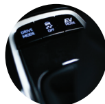
Conducción eléctrica EV Mode
