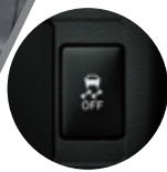
Control electrónico de estabilidad (VSC) Control de tracción (TRC)
